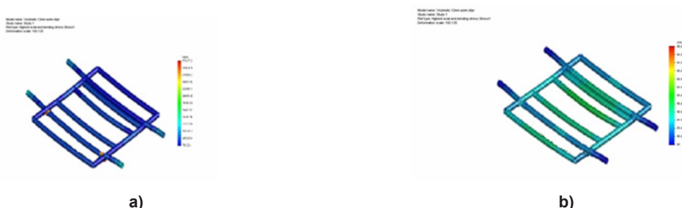
8 pav. Laikančiosios rėminės konstrukcijos stipruminiai parametrai: a – max įtempimai, b – max poslinkiai
