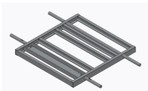
4 pav. Suprojektuota „SolidWorks“ modeliavimo programa važiuoklės laikančioji rėminė konstrukcija
